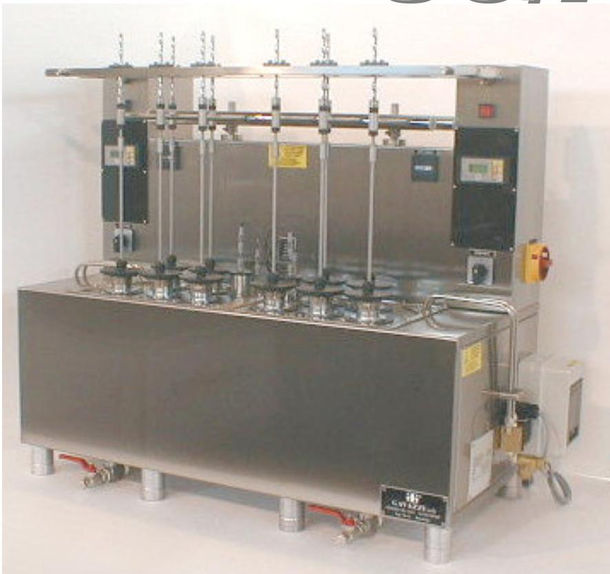
Apparecchio da laboratorio per tintura, universalmente impiegabile per fibre tessili, naturali, sintetiche o miste sia in pezza, fiocco o matassa con procedimento per esaurimento; il più diffuso sul mercato capace di due bagni simultanei con programmi diversi.
