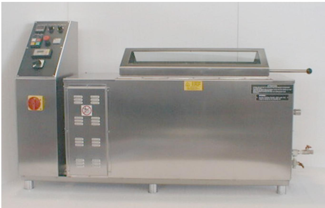
Apparecchio da laboratorio per tintura atmosferica campioni tessili, universalmente impiegabile per fibre tessili, naturali, sintetiche o miste. La tintura avviene con il passaggio del tessuto in piano in una bacinella, con cicli ripetitivi.
