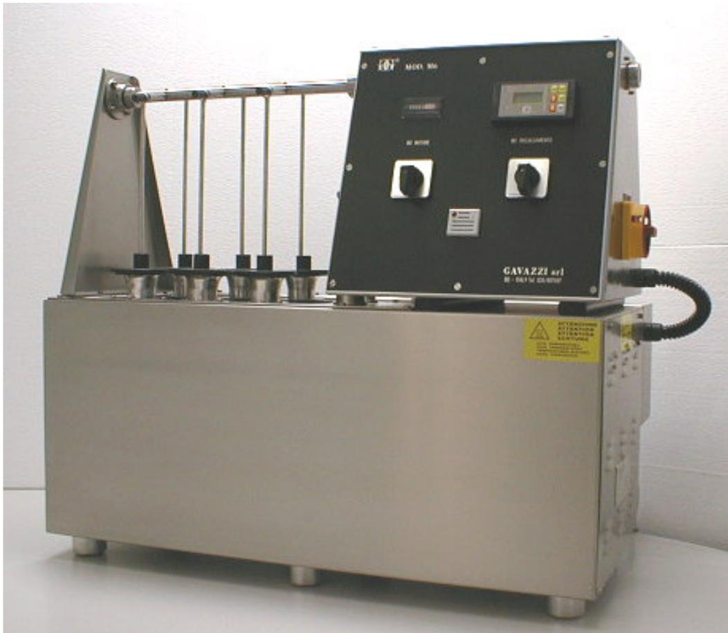
Apparecchio da laboratorio per tintura, universalmente impiegabile per fibre tessili, naturali, sintetiche o miste sia in pezza, fiocco o matassa con procedimento per esaurimento.
